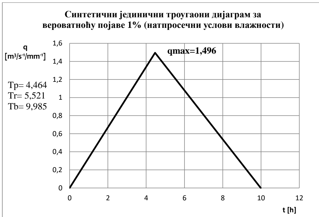
Слика 11. Синтетички јединични троугаони хидрограм за натпросечне услове влажности након изведених радова (извор: аутор)
