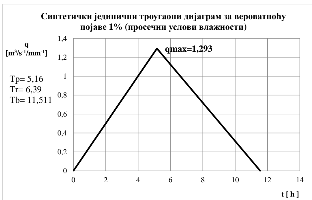
Слика 9. Синтетички јединични троугаони хидрограм за просечне услове влажности након изведених радова (извор: аутор)
