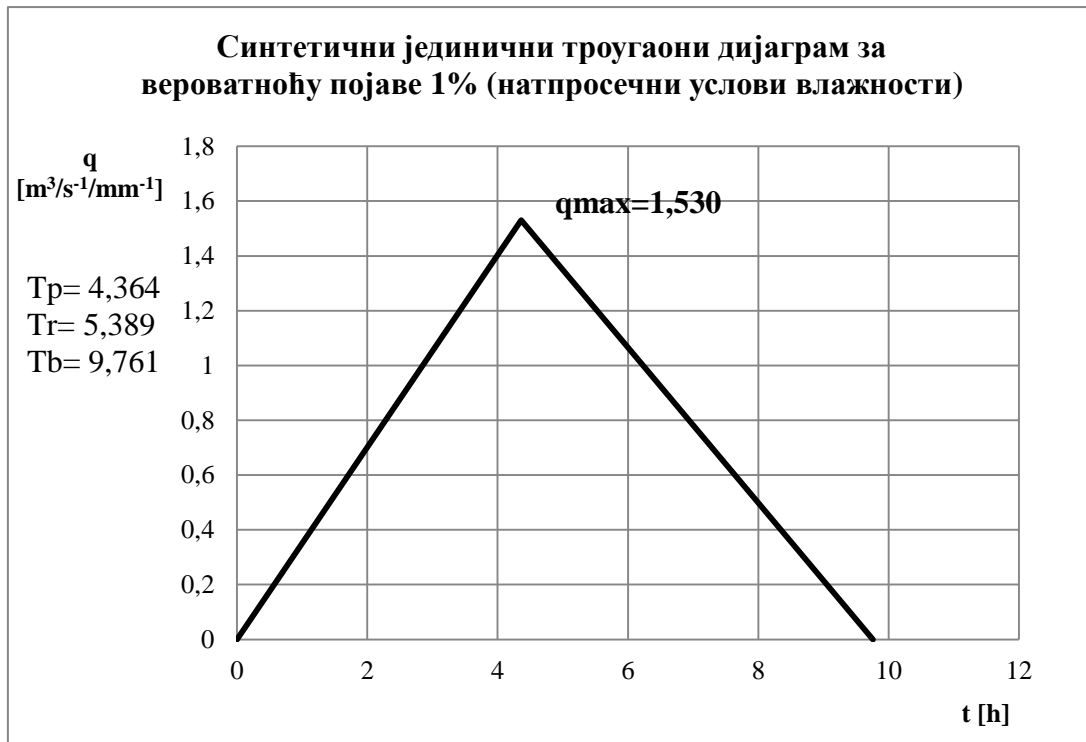
Слика 7. Синтетички јединични троугаони хидрограм за натпросечне услове влажности пре изведених радова (извор: аутор)
