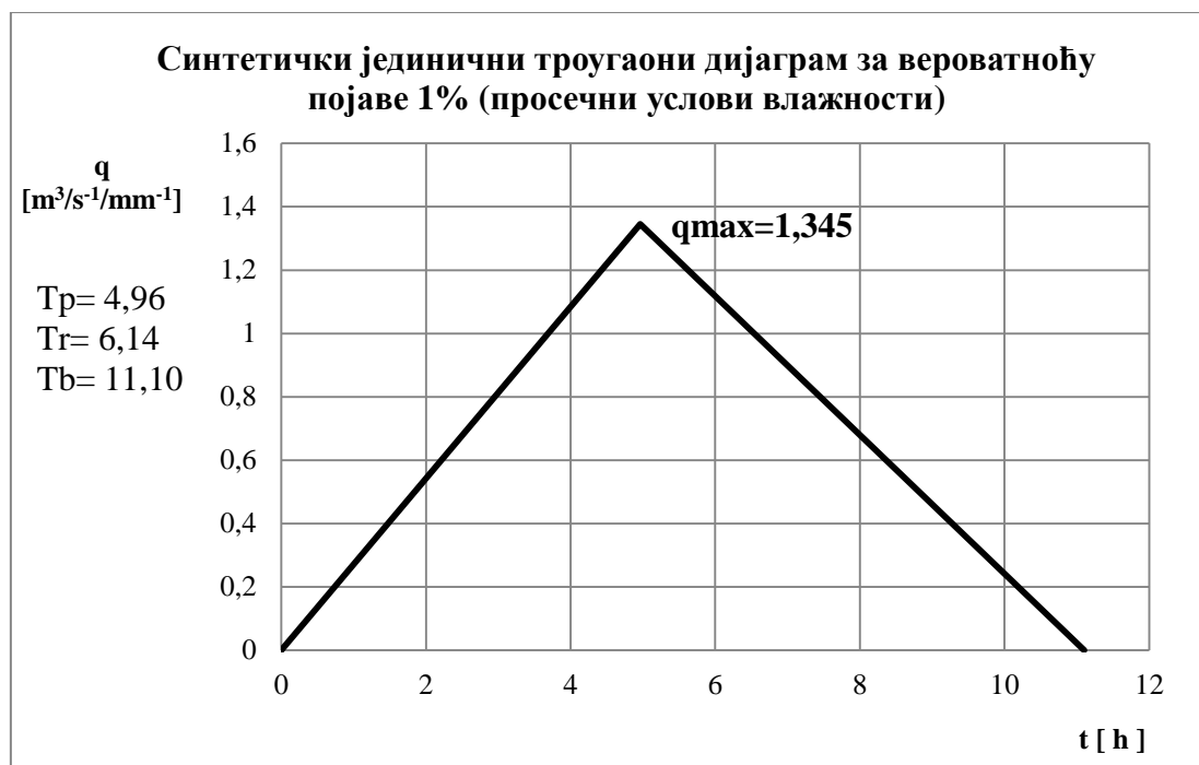
Слика 5. Синтетички јединични троугаони хидрограм за просечне услове влажности пре изведених радова (извор: аутор)
