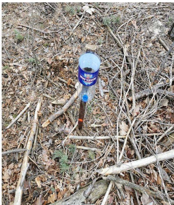
Fotografija 1 i 2: Prikaz improviziranih kišomjera unutar sastojine i na otvorenom (autor: Hodžić, A.)
