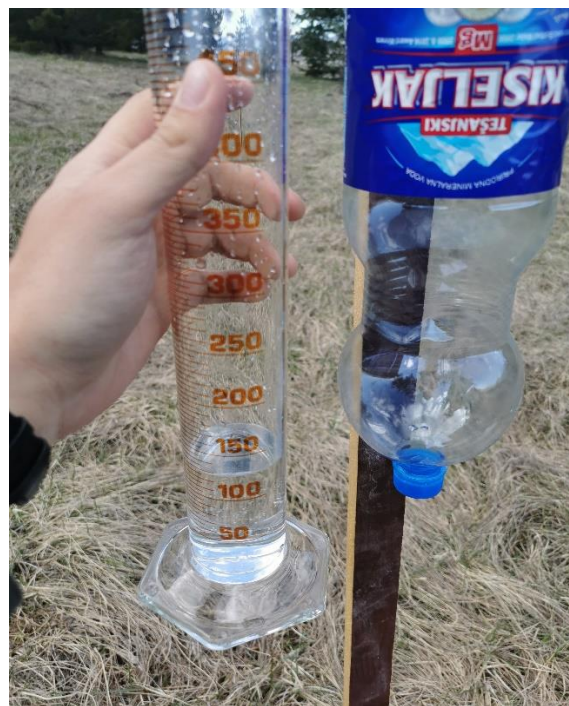
Fotografija 1 i 2: Prikaz improviziranih kišomjera unutar sastojine i na otvorenom (autor: Hodžić, A.)
