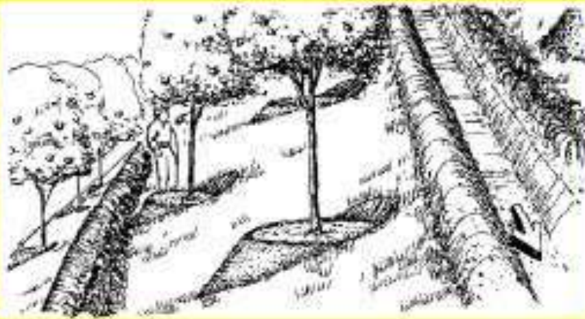
Слика 21: Дренажен ров за свлечишта, контуирен ров, контурни бразди отворени со рипер со странично крило
